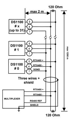
Figure 8 - DS1100 Multidrop Connection to a Multiplexer
