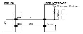
Figure 13 - DS1100 Output Connections
