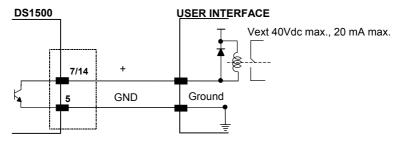
Figure 15 - DS1500 Output Connections
