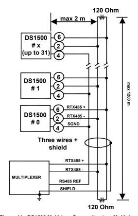
Figure 11 - DS1500 Multidrop Connection to a Multiplexer
